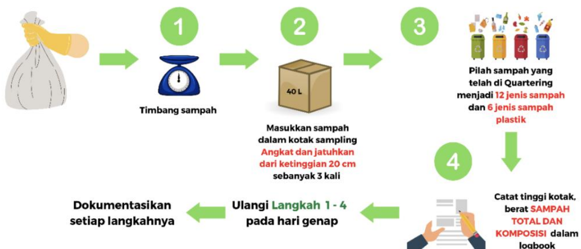
Gambar 3.4 Alur Kerja Pengukuran Sampel Sumber Rumah Tangga dan Non Rumah Tangga Bervolume Kecil
